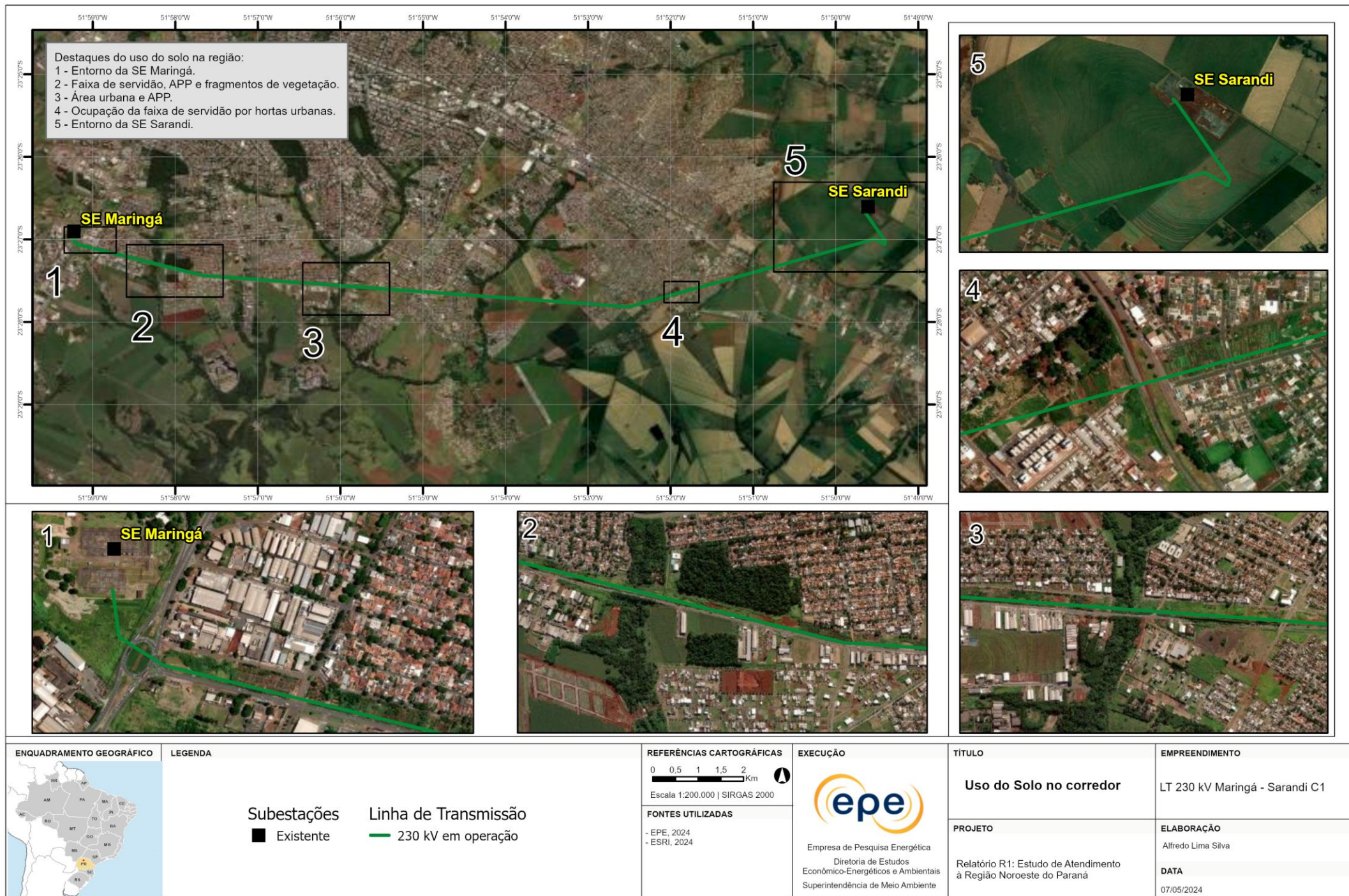
Figura 4 – Uso do solo na faixa de servidão da LT 230 kV Maringá – Sarandi C1
