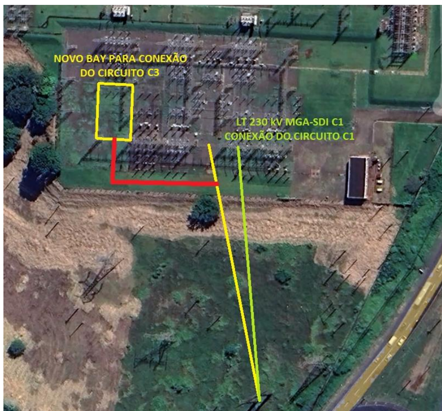
Figura 3-5 – Conexão dos circuitos C1 e C3 da LT 230 kV Maringá – Sarandi na Subestação Maringá
