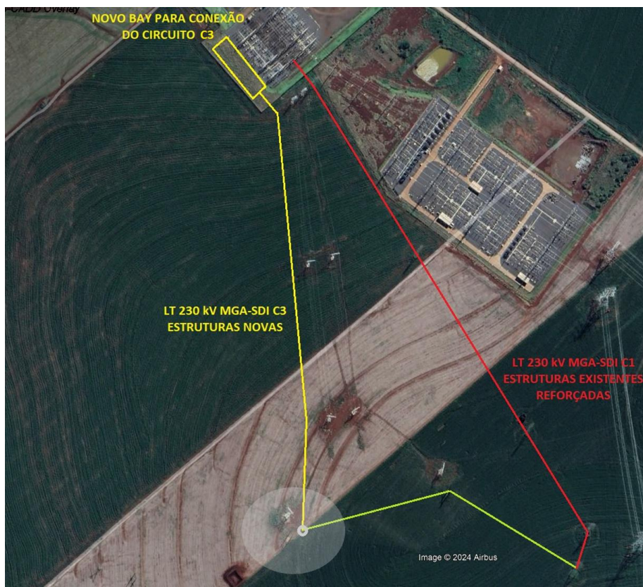
Figura 3-6 – Conexão dos circuitos C1 e C3 da LT 230 kV Maringá – Sarandi na Subestação Sarandi
